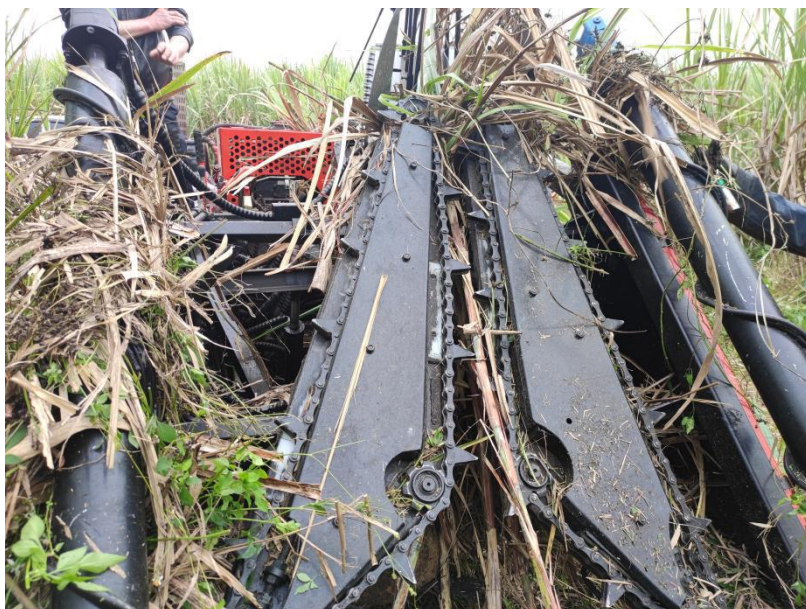
图 6 通达 4GD-200 型喂入口堵塞
