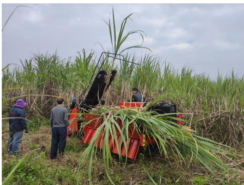
图3 百域 4GD-300 型甘蔗割堆机以遥控方式进行性能试验
