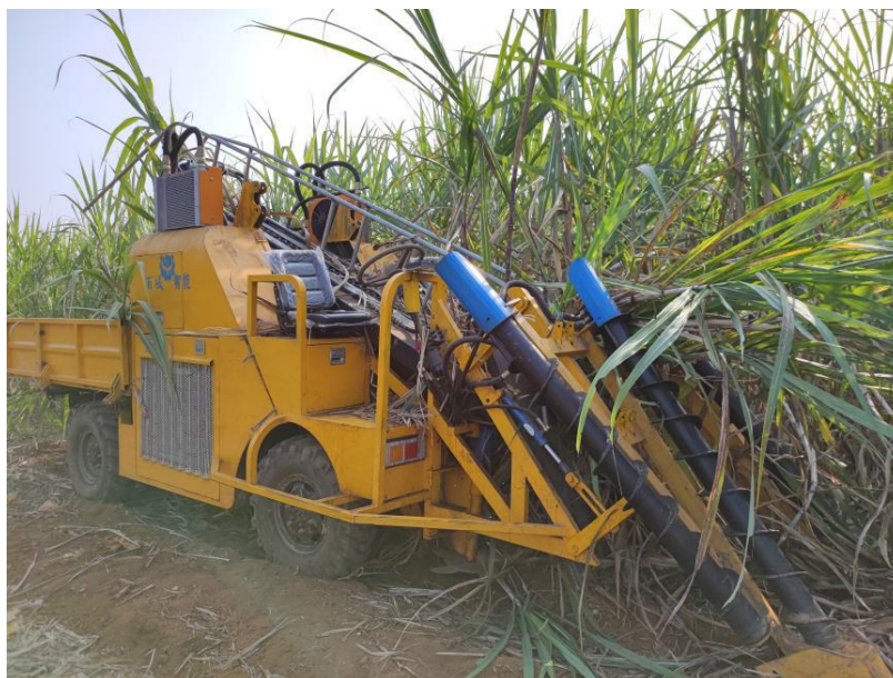
图3 百域 4GD-300 型甘蔗割堆机以遥控方式进行性能试验
