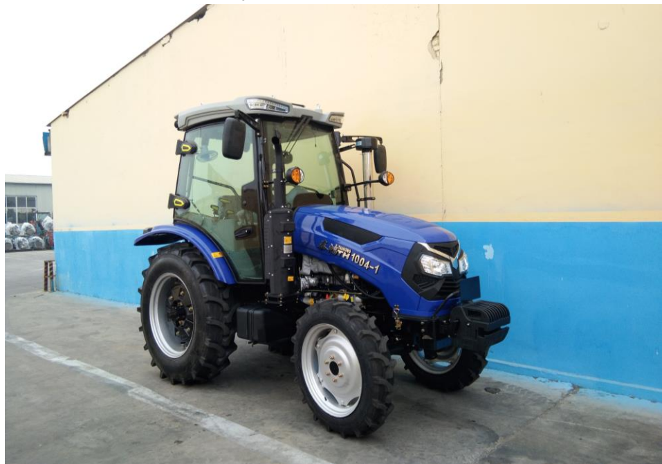
TH1004-1 型轮式拖拉机（主机型选装 TH1504.45.002 型驾驶室）
