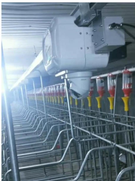
定位栏上部署巡检机器人
