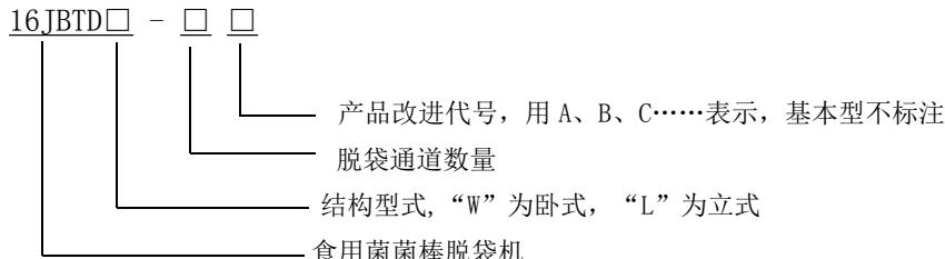
示例：结构型式为卧式的食用菌菌棒脱袋机基本型，脱袋通道数量4个，其型号表示为：16JBTDW-4。
