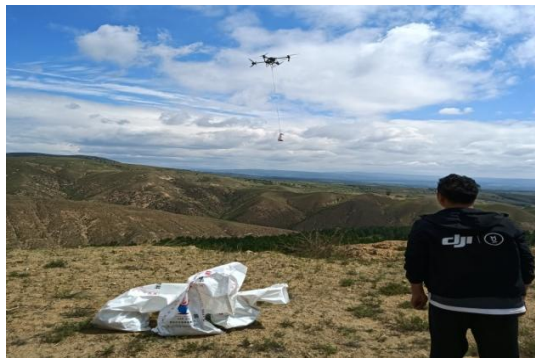
无人机撒施腐殖酸立地难退化区草种人工补播
